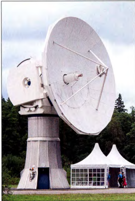
Schnell drehbare Ka-Band-Antenne mit 13 m Durchmesser
