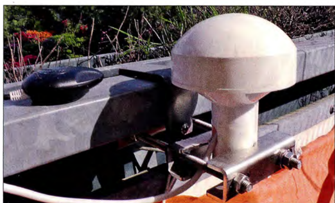
Bild 1: Links der GNSS-Empfänger Navilock NL-8002U, der mittels Magnetfuß auf metallischen Untergründen fixierbar ist; rechts die dem Transceiver zuzuführende GPS-Antenne für das 10-MHz-Referenzsignal
