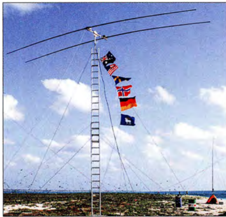
Als Träger für die 2-Element-Yagi von Stepp-IR diente eine auf 9 m ausziehbare Leiter.
