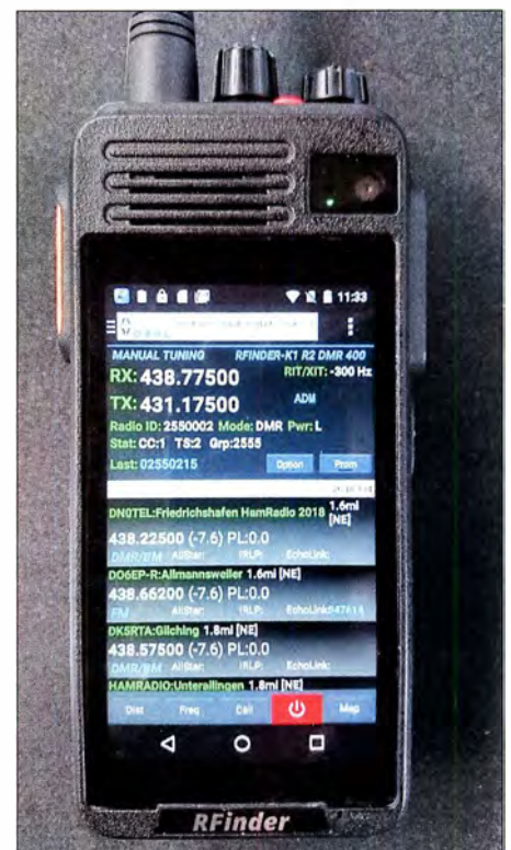
Der RFinder K1 (684 € plus Versand) ist ein von Runbo in China gefertigtes Handfunk-sprechgerät für 2 m oder 70 cm FM und DMR mit einem integrierten LTE-Android-Smartphone. Dank W2CYKs Repeater-App RFinder entfällt ein Hantieren mit Codeplugs.
