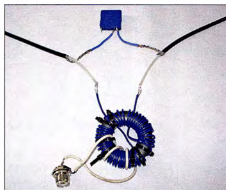
Bild 4: Zentraler Umschalt­punkt mit Anpassübertrager als Versuchsaufbau; oben das Relais
