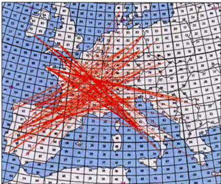
Bei der ersten „richtigen“ 2-m-Sporadic-E des Jahres 2018 entwickelten sich am 28.5. über Zentralfrankreich Reflexionsgebiete, die QSOs von EA nach DL, G/EI nach I und F nach YU ermöglichten. Grafik: mmmmonvhf.de
