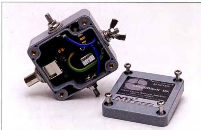
Bild 1: Das wetterfeste Gehäuse (Prototyp) des MD300DX mit BNC-Buchse und den Anschlüssen für die Dipolelemente sowie für Erde; oben links in der Mitte auf der Platine lässt sich mit einem Kurzschlussstecker die Verstärkung zwischen 0 dB und 3 dB ändern.
