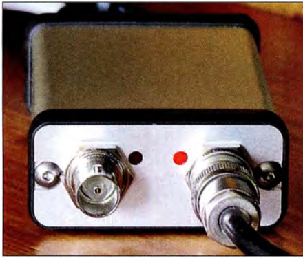
Bild 10: Die Referenz des britischen Herstellers Leo Bodnar mit Anschlüssen für zwei Empfänger oder Transceiver
